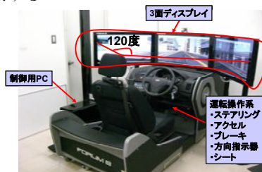
図1 運転能力測定シミュレータの全体構成
