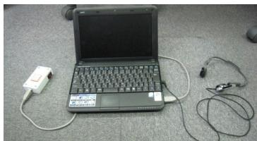
図 1 : システム構成 (左から GPS モジュール、ノート PC、骨伝導ヘッドホン)
